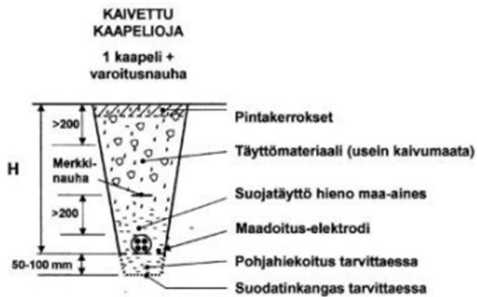
KUVA 2 KAAPELIKAIVANTO
